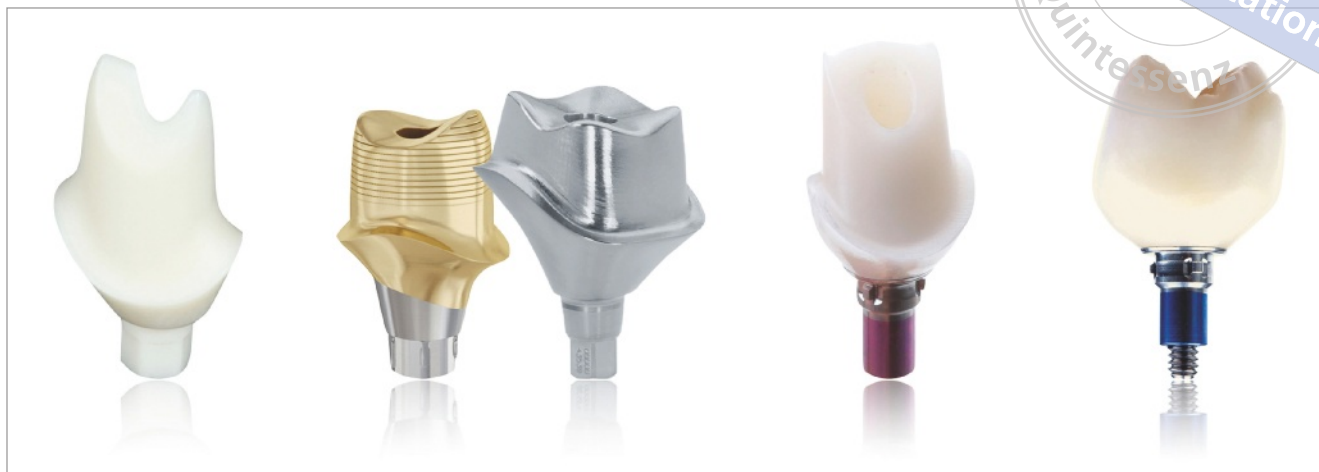
Abb. 1 CAD/CAM-generierte Implantataufbauten mit unterschiedlicher Anschlussgeometrie. Von links nach rechts: einteiliges Zirkonoxid-, titannitridbeschichtetes Titan- und Titanabutment sowie zweiteiliges Hybridabutment mit Titaninsert bzw. Crownabutment auf Titaninsert
