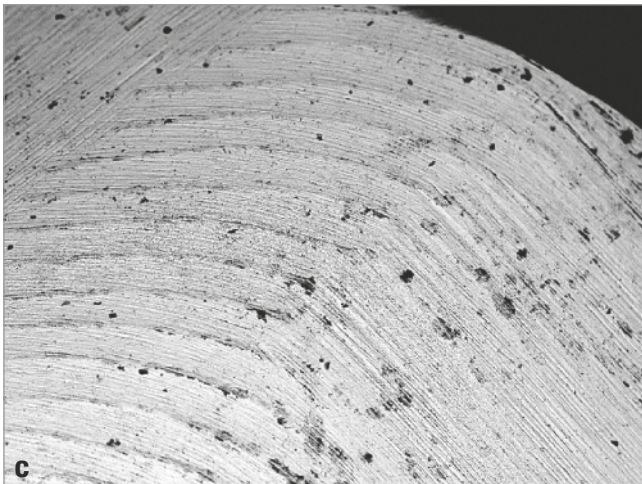
Abb. 6a bis d Rasterelektronische Aufnahmen (Vergrößerung 500x und 100x) eines CAD/CAM-Zirkonoxidabutments vor (a, c) und nach (b, d) der Drei-Stufen-Ultraschallreinigung. Das Reinigungsprotokoll führt zu einer deutlichen Minimierung der herstellungsbedingten Ein- und Auflagerungspartikel (aus: Gehrke et al. 13 )
