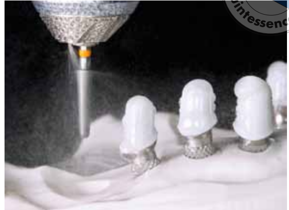
Abb. 5 Die CAD/CAM-generierten Patrizen werden im Parallelfräsgerät unter Wasserkühlung feingeschliffen.
