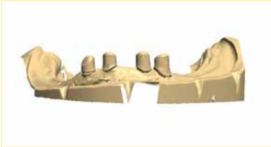
Abb. 8 Scan der Galvanokappen als Grundlage für das CAD-Design der Tertiärstruktur.
