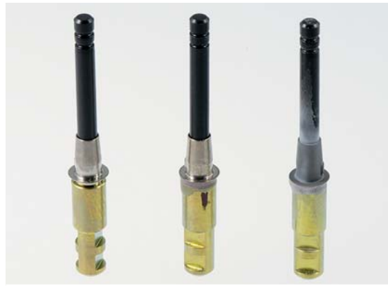
► Abb. 4 Zum Schutz der konfektionierten Schnittstelle wird diese sorgfältig mit Wachs abgedeckt. Rechts die Titanklebebasis nach dem Abstrahlen.
